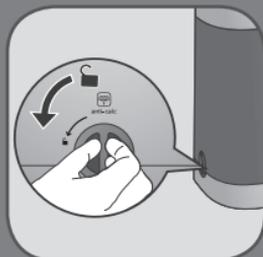
**HU** Helyezze a készüléket a mosdó fölé, és csavarja le a «Vízkötlentítő» kupakot, az óramutató járásával ellentétes irányba forgatva azt.
