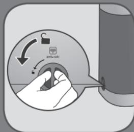
**LV** Novietojiet ierīci virs izlietnes un atskrūvējiet „Anti Calc” atkaļķošanas vāciņu, pagriežot pretēji pulksteņrādītāja kustības virzienam.
