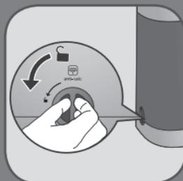
**PL** Umieść urządzenie nad zlewem i odkręć zawór 'anti-calc' przekręcając go w kierunku przeciwnym do ruchu wskazówek zegara.
