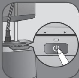
**PL** Wcisnąc długo przycisk on/off, aby wyłączyć urządzenie.
