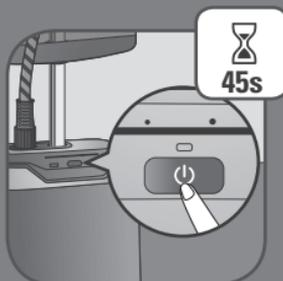
**LV** Lai ieslēgtu ierīci, nospiediet ieslēgšanas/izslēgšanas pogu „ON/OFF”. 45 sekundes maksimālajā līmenī mirgos tvaika līmeņa gaismas diode.
