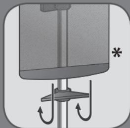
**SV** Lossa stödet och sätt i det i den justerbara kroken genom att justera spänningen med kroken och låsa den.
