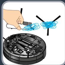
**RU** Чтобы очистить боковую щетку, разблокируйте ее, а затем снимите и очистите ее с помощью кисточки для очистки. Также прочистите труднодоступные места в отверстии боковой щетки. Очищайте боковые щетки один раз в месяц.
