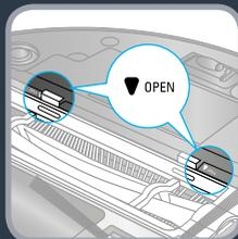
**RU** Установите щетку и защиту щетки на место. Убедитесь, что резиновая часть на кончике щетки установлена на место. Закрепите защиту щетки с помощью двух фиксаторов.
