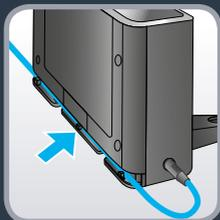
**RU** Подключите блок питания к разъему питания с боковой стороны станции. Уберите излишек кабеля на задней стороне основания в специальный отсек. Используйте только зарядное устройство, поставляемое с роботом-пылесосом. Не используйте универсальные зарядные устройства.
