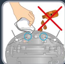
**RU** Чтобы очистить контактные пластины, выключите робот-пылесос и переверните его. Затем протрите пластины сухой тканью. Не протирайте маслом. Очищайте контактные пластины один раз в неделю.
