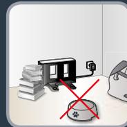
**RU** Разместите зарядную станцию таким образом, чтобы с каждой стороны от нее оставалось по 0,5 м свободного пространства, а перед ней – 1 м. Не ставьте зарядную станцию рядом с лестницей. Кабель должен быть натяннут. Размещайте зарядную станцию на твердой поверхности. Не размещайте зарядную станцию на коврах.
