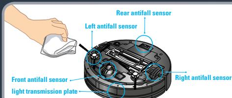
**RU** Чтобы эффективность робота-пылесоса не снижалась вследствие накопления пыли, рекомендуется каждую неделю тщательно протирать камеру, окошко лазера и датчик сухой хлопковой тканью.
