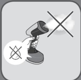
**ES** Haga funcionar el aparato hasta que el depósito de agua se haya vaciado por completo.
