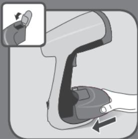
**FI** Aseta vesisäiliö takaisin laitteeseen. Varmista, että vesisäiliö on kunnolla kiinni ja lukittu.
