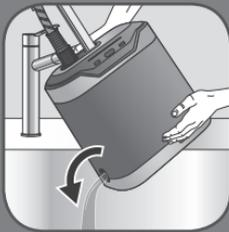
**ZH** 將機身垂直傾側，將所有水倒進鋅盤。
