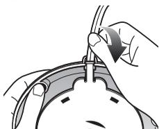
電源プレートの切り込みを押しひろげながら、コードを手前に引っばって切り込みからコードをはずします。
