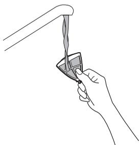
フィルターのタブを持ってケトル本体からフィルターを引き抜き、水洗いしてください。洗浄後は、乾かしてから、再度しっかり注ぎ口にセットします。
