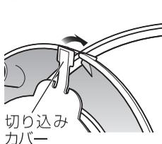
電源プレートの裏側にコードを巻き付けたあと、コードを切り込みにセットして、切り込みカバーをカチッと音がするまで押し込みます。
