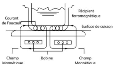
l'alimentation de la bobine, le récipient est échauffé. Les aliments sont ensuite chauffés par contact avec le dessous de la poêle.
