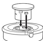
② 計量キャップを時計回りに回して固定します。
