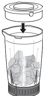
② ふたを時計回りに回し、ふたの内側のみぞとミキサー容器の突起を合わせて固定します。
