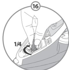
\*DE Reinigung des Anti-Kalk-Stabs (einmal monatlich) • FR Nettoyage de la tige anti calcaire (une fois par mois) • NL Anti-kalkstaafje reinigen (1 x per maand) • IT Pulizia della valvola anticalc (una volta al mese)
